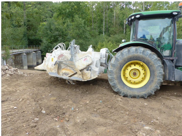
▲ Figure 5. Concasseur à pierres utilisé pour concasser les racines de renouée en surface. Y. L.
