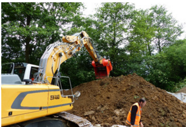
▼ Figure 3. Concassage de la renouée sur le site du Libaret à Port-Brillet en 2016. N. B.
